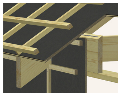
Seinän ja katon liitos, räystäälle jatkuvat yläpaarteet
