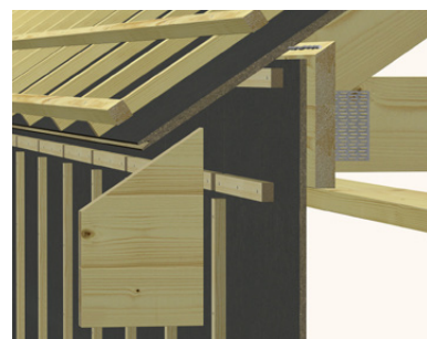
Seinän ja katon liitos, erilliset aluspuut
