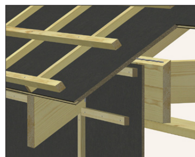
Övergång vägg/tak med utstickande takstolar/takbalkar
